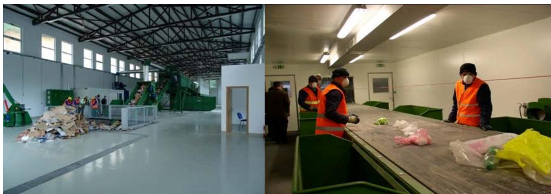
Slike 8 i 9. Prikaz unutrašnjosti sortirnice i procesa sortiranja otpada
